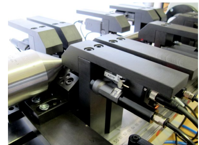
Mehrstellenmessvorrichtung für Präzisionswellen Multi-position measuring system for precision shafts
